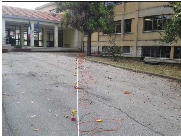
foto dello stendimento di sismica MASW-REMI - lunghezza stendimento 32 m, distanza intergeofonica 2 m
