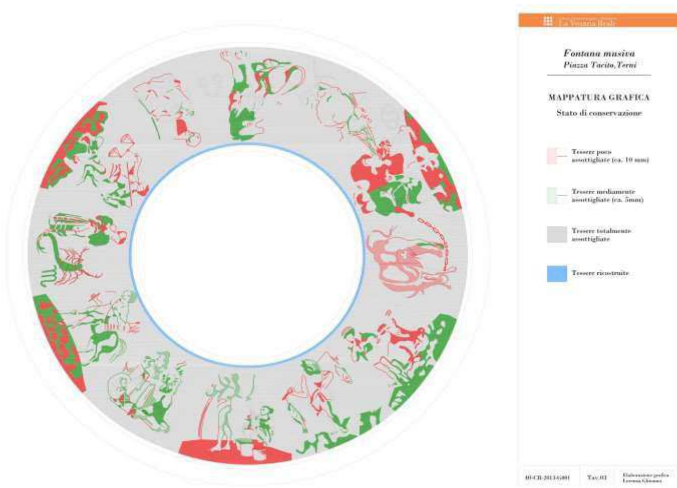
Fig.5 - Rilievo dello stato di conservazione (La Venaria Reale 2013). Le tessere risultano assottigliate in modo differenziato a seconda del materiale utilizzato ed il bordo interno è frutto di rifacimento.
