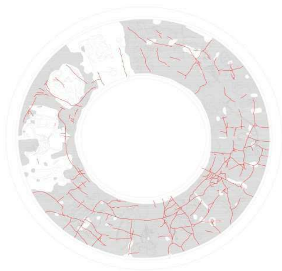
Fig.3 - Rilievo dello stato di conservazione (La Venaria Reale 2013). Il mosaico risulta in gran parte staccato dal massetto armato della vasca ("rudus") e fittamente fessurato.
