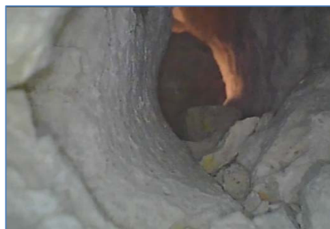
EM9.3 - 35 cm da inizio foro, muratura in pietra con piccole discontinuità
