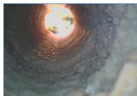
EM6.4 - 45 cm da inizio foro, muratura in mattoni pieni
