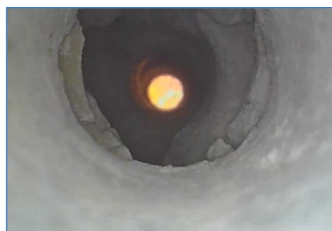
EM2.4 - 55 cm da inizio foro, muratura in pietra con piccole discontinuità
