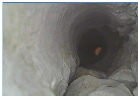
EM4.2 - 20 cm da inizio foro, muratura in pietra con piccole discontinuità
