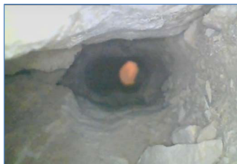
EM4.3 - 40 cm da inizio foro, muratura in pietra con piccole discontinuità
