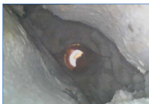
EM5.2 - 15 cm da inizio foro, muratura in pietra con piccole discontinuità
