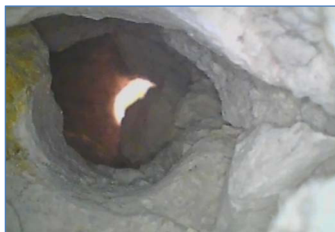
EM5.3 - 30 cm da inizio foro, muratura in pietra con piccole discontinuità
