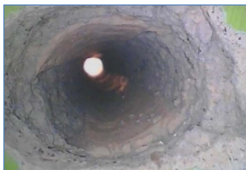
EM6.1 - inizio foro, muratura in mattoni pieni
