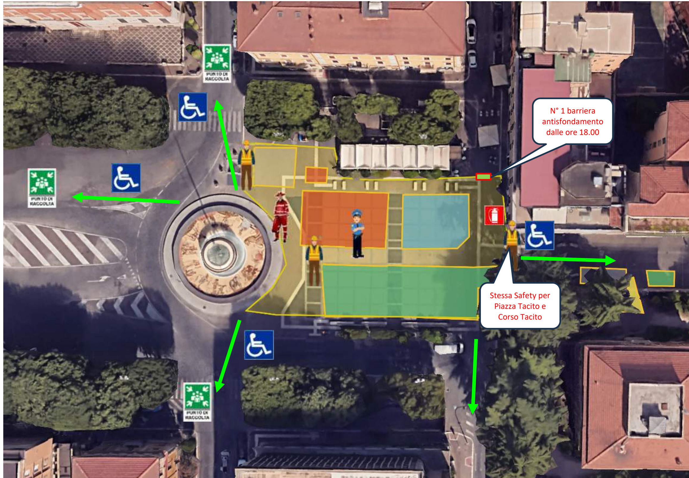
Immagine 14 Corso Tacito - Safety, Security, Antincendio, Via di Esodo, barriere antisfondamento
