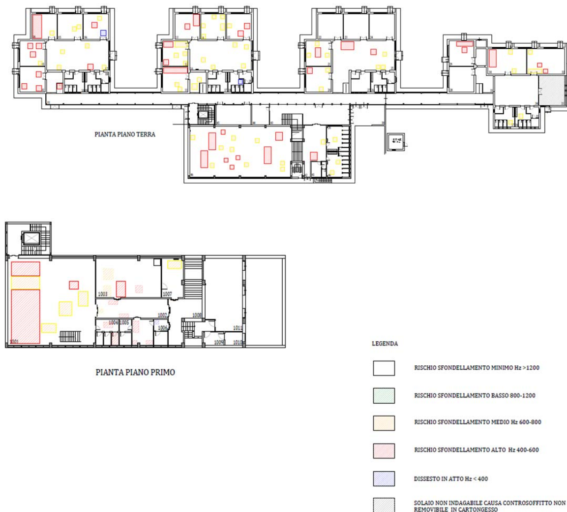
Figura 55: Estratto indagini su solai e controsoffitti - Indagine sfondellamento
