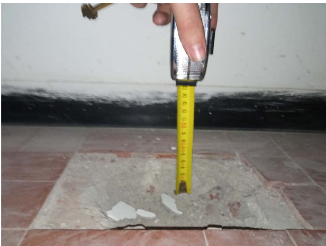
Figura 68: Saggio per misurazione massetto inclinato piano sottotetto (ex "loggione" del teatro posto nell'attuale mensa)
