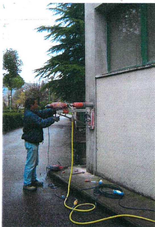
Figura 43: Estratto campagna prove sui materiali - Edificio C - Verifica vulnerabilità sismica
