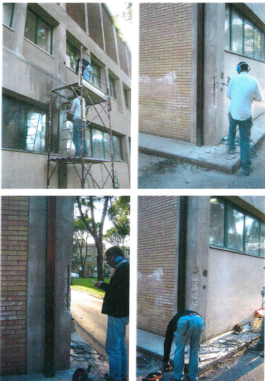
Figura 45: Estratto campagna prove sui materiali - Edificio C - Verifica vulnerabilità sismica
