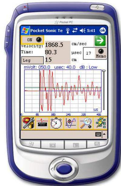
Strumentazione BOVIAR CMS v3 per misure di velocità sonica.
